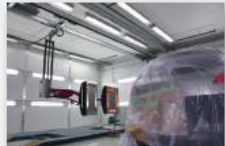
INSTALAÇÃO DE EQUIPAMENTO INFRAVERMELHO COM SISTEMA DE TRILHOS AÉREOS
